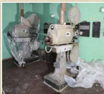
Original Filmrollen und Projektoren. Zwischen zwei Graphitstiften entstand ein Lichtbogen welcher über einen gewölbten Spiegel den starken Lichtstrahl erzeugte. Auftretende Hitze und Dämpfe entfleuchten durch Ofenrohre ins Freie.
